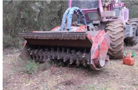
Figure 8. Gyrobroyeur à marteaux utilisé pour l'entretien des coupures de combustible.
